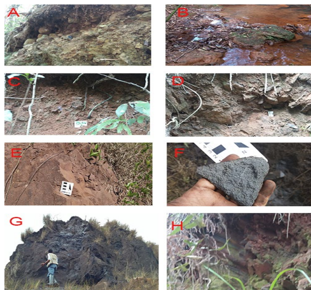
Figura 8: Sedimentos coletados: A e B: Aluvião, C e D: Colúvio, E: Arenito Ferruginoso (Formação Fonseca), F: BIF (Formação Fonseca), G: Elúvio- Linhito (Formação Fonseca), H: Elúvio- Filito.
